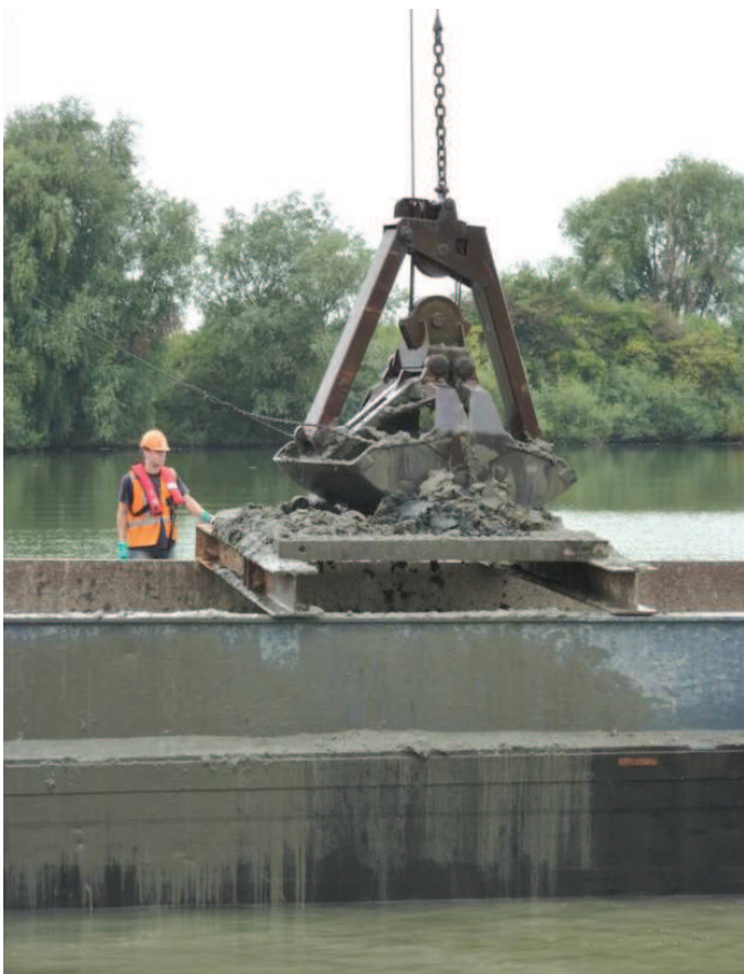
Afb. 3.2 Met een draadkraan werd opgebaggerd sediment over een zeefrooster van 10 x 10 cm gegooid en uitgezocht op eventuele vondsten. (Foto J. Flamman, Vestigia).
